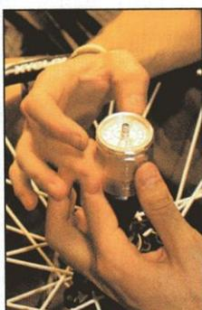
mesurer ce couple de frottement, nous avons utilisé un couple mètre. Nous avons mesuré les frictions, exprimées en N. mm, sur les moyeux "à vide" puis avec un blocage rapide serré, c'est-à-dire en charge, comme lorsque la roue est montée sur le vélo ou la fourche.
